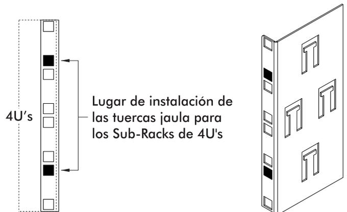
2. Coloque el Sub-Rack en el lugar para instalarse. Mantenga el Sub-Rack centrado en los puntos de fijación con la tuerca jaula.
