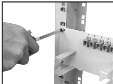
**1-** Com uma chave Philips, fixe os adaptadores ópticos ao painel. Os furos já possuem rosca, dispensando portanto o uso de porcas. Em seguida, fixe o **Painel SLIM** ao rack;
