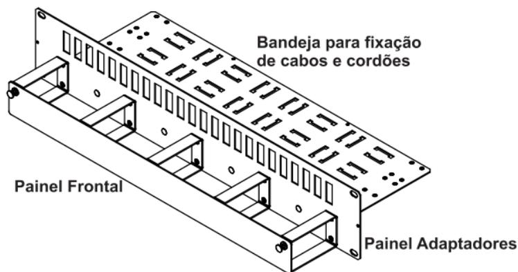
O **PAINEL SLIM** foi desenvolvido para organizar e proteger os cordões ópticos através do sistema de espelhamento, contribuindo para o máximo aproveitamento do espaço físico das redes ópticas, preservando fatores essenciais no gerenciamento da rede, como: visibilidade, acessibilidade das conexões e fácil manuseio.
