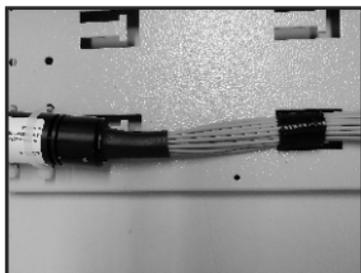
**3-** Utilizando el Velcro doble cara, haga la fijación y organización de los cordones en la bandeja del **Painel Slim144** (utilice los rasgos perfil C).
