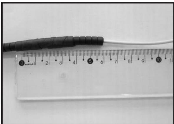
6. Corte 4,0 cm de la cinta de auto fusión y proteja el otro extremo de los tubos de protección flexibles.
