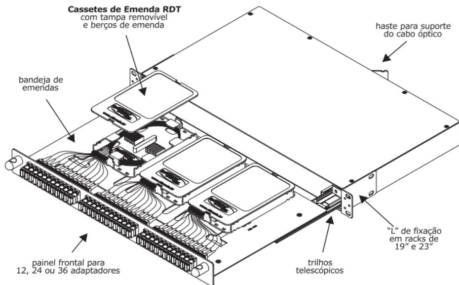
O **DIO Office** possui diferenciais exclusivos que o fazem a melhor opção da categoria, como: sistema de acomodação do tubo loose na própria bandeja; modularidade dos cassetes de emenda; trilho telescópico removível, resistente e com trava confiável; roscas na furação dos adaptadores; acabamento criterioso, sem cantos vivos.
