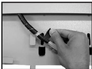
7- Encaixe a bandeja de emendas do **DIO**; enrole um pedaço de fita de auto fusão envolvendo os tubos loose no término do tubo espiral.
