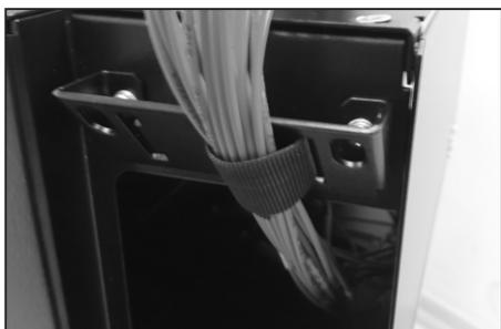
**4-** Instalação dos Cordões ópticos: Fixe os cordões ópticos no suporte traseiro utilizando o Velcro dupla face e encaminhe para o interior do **DIO HDS4**.
