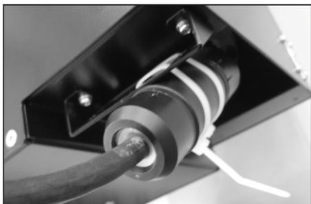
**3-** Instalação dos Cabos ópticos Junção ou Breakout: Utilizando as abraçadeiras de Nylon de 150mm fixe a junção ou o cabo Breakout no suporte traseiro e encaminhe para o interior do **DIO HDS4**.
