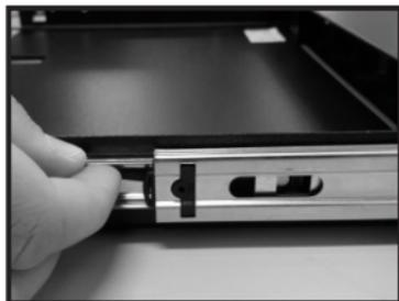
**2-** Abra totalmente o **DIO EC072** e remova a bandeja, destravando o dispositivo do trilho telescópico (localizado na lateral da bandeja);
