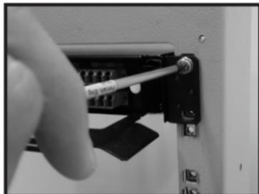
**1-** Encaixe as porcas-gaiola no plano frontal de fixação do bastidor; e com uma chave Philips fixe o **DIO EC072** usando os parafusos e aruelas lisas M5 presentes no kit de fixação;
