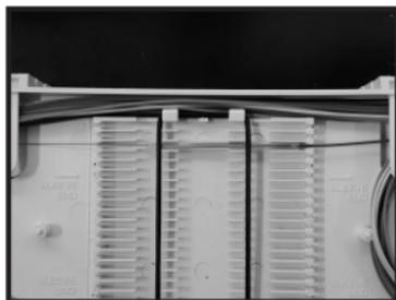
**9-** Retire os pigtails do Cassete de Emenda e faça as fusões ópticas. Retorne os pigtails ao cassette, acomodando os protetores de emendas no berço;
