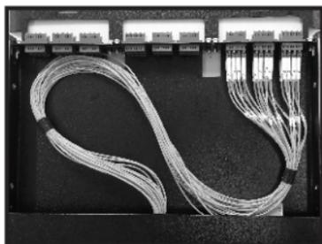
7- Organize os cordões ópticos no interior da bandeja de maneira a formar um "S" para facilitar a sua abertura. Faça as conectorizações necessárias;
