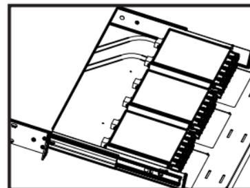
**12-** Insira os Cabo trunk (fanout) ou Harness pela traseira do Dio Eco guiando até o módulo MTP e faça a conectorização
