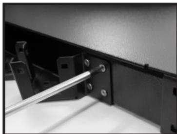
**3-** Com uma chave Philips fixe, utilizando os 08 parafusos M3 presentes no kit de acessórios, o suporte inclinado na parte traseira do **DIO EC072**;
