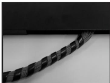
3- Organize a saída dos cordões ópticos, utilizando o espiral plástico fornecido no kit de instalação;
