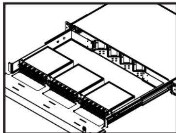
**11-** Com os módulos MTP instalados nos locais indicados e comece a preparar Dio Eco para instalação dos Cabo Trunk ou Harness.
