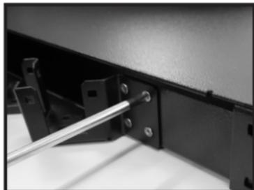
5- Com uma chave Philips fixe, utilizando os 08 parafusos M3 presentes no kit de acessórios, o suporte inclinado na parte traseira do **DIO EC072**;
