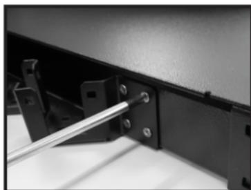
3- Con un destornillador Philips fije, utilizando los 08 tornillos M3 incluidos en el kit de accesorios, el soporte inclinado en la parte posterior de **DIO EC072**;
