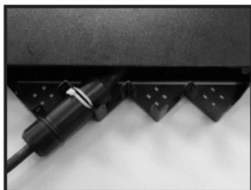
6- Utilizando las abrazaderas de nylon de 150mm fije el empalme o el cable break out en el inclinado posterior;
