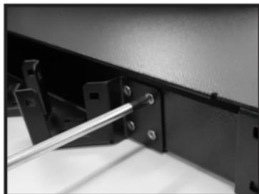
5- Con un destornillador Philips fije, utilizando los 08 tornillos M3 incluidos en el kit de accesorios, el soporte inclinado en la parte posterior de **DIO EC072**;
