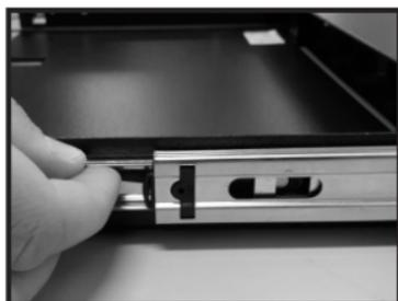
2- Abra totalmente el **DIO EC072** y remueva la bandeja, desbloqueando el dispositivo del riel telescópico (situado en la parte lateral de la bandeja);
