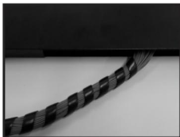
3- Organice la salida de los cables ópticos, utilizando el espiral plástico incluido en el kit de instalación;
