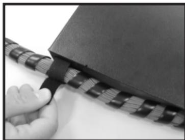
4- Utilice las ranuras en el chasis del **DIO EC072** para fijar los cordones ópticos, organizados con el espiral, con el velcro doble cara;
