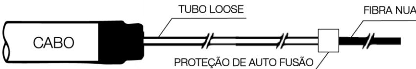
**PT** Decape 3 metros do cabo óptico não conectorizado (tubo Loose). Proteja a região de encontro da jaqueta do cabo com o tubo flexível com a fita de auto fusão. Decape 1,5 metros do tubo Loose e prepare as fibras nuas para a fusão.
