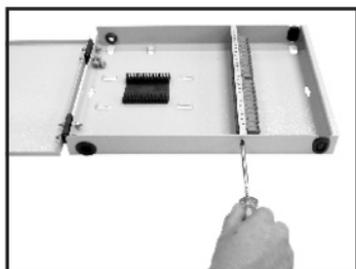
**1** - Com uma chave Philips, retire o painel interno do **DGO P-24**; fixe os adaptadores no painel e o retorne ao mesmo local. (os adaptadores SC são colocados pela frente do painel e os E2000 por trás);
