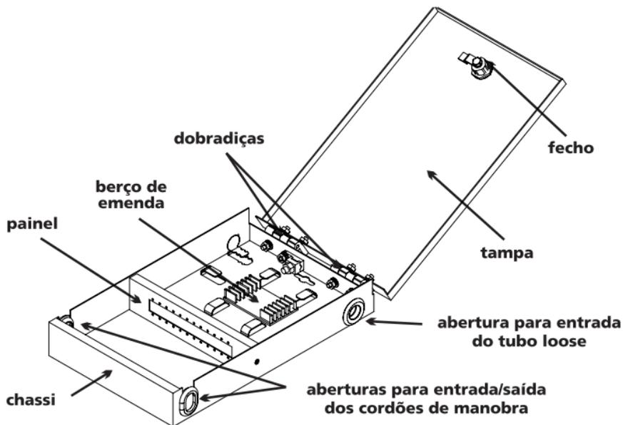
O **DGO P-12** foi desenvolvido para atender os clientes corporativos que necessitam de flexibilidade na instalação e manutenção da rede óptica, aliada ao baixo custo. Para fixação em paredes, o **DGO P-12** é ideal para redes que necessitam de otimização do espaço.
