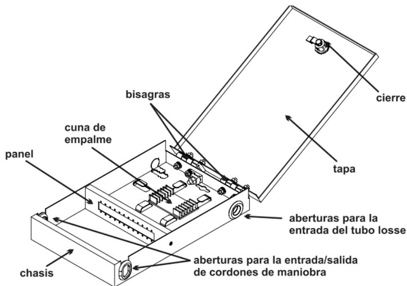
El **DGO P-12** está diseñado para hacer satisfacer a los clientes corporativos que requieren flexibilidad en la instalación y mantenimiento de la red óptica, combinando el bajo costo. Para la fijación en paredes, el **DGO P-12** es ideal para redes que requieran optimización del espacio.
