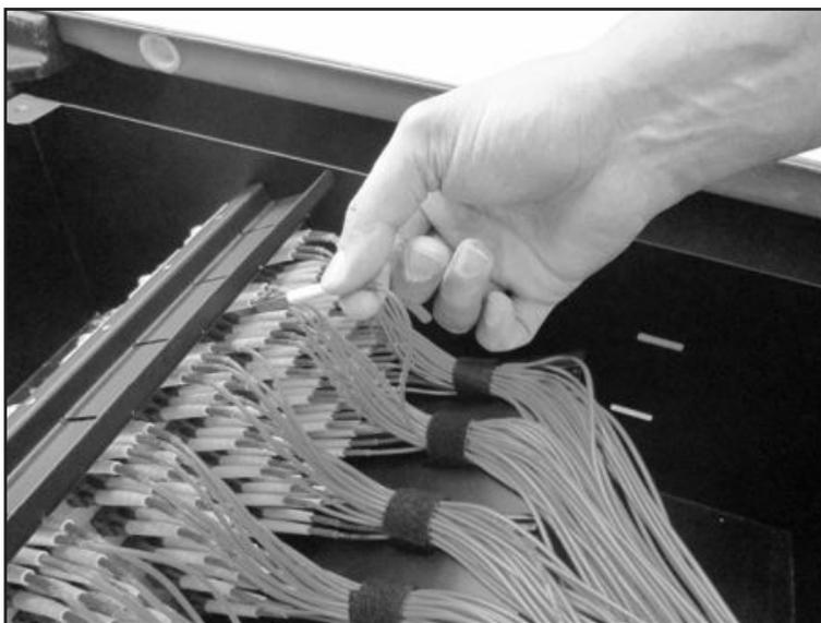
**7-** Faça as conectorizações traseiras necessárias. Utilize as porcas borboletas laterais para alterar o ângulo do suporte interno facilitando as conectorizações.
