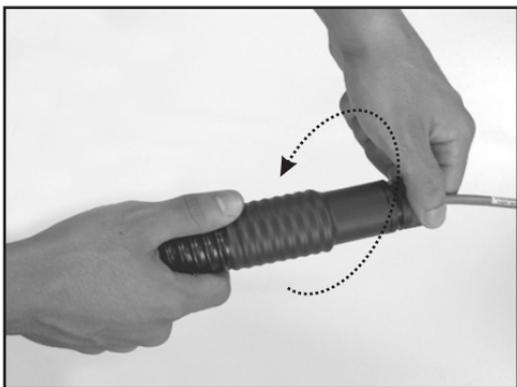
2- Remueva la cubierta protectora de los conectores destornillando la base del tubo corrugado.
