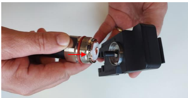
Regrese el cuerpo del conector hacia adelante para abocardar el conductor externo usando la herramienta, como en la foto
