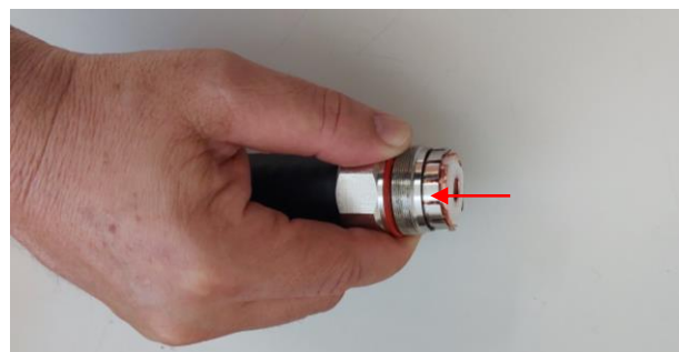
Coloque el cuerpo del conector presionando hasta llegar al límite como en la foto
