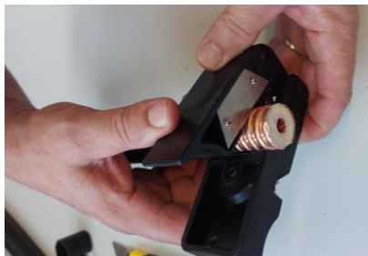
Posicione el cable en la herramienta como en la foto. Asegúrese que la cuchilla grande quede en la parte superior de la corrugación
