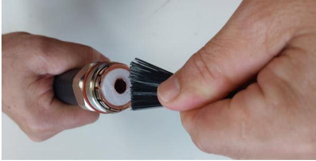
Limpie las limaduras con un cepillo de acero
