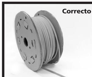
No desenrolle la bobina en la horizontal para evitar que el cable se quede con espirales.
