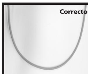
No se puede presionar el cable más que su radio mínimo de curvatura, es decir, no debe curvarse más que el radio de la bobina.
