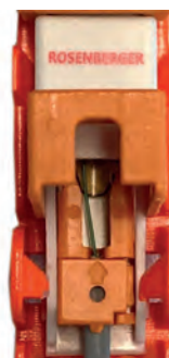
Janela de inspeção de fibra
