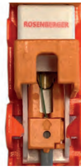
Ventana de inspección de fibra
