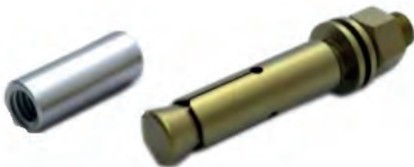
Prolongador y Anclador 1/4" a 5/8" Ø21 X 55 mm - Prolongador 1/4" a 5/8" Ø21 X 122 mm Material: Acero Acabado galvanizado o bicromatado.
